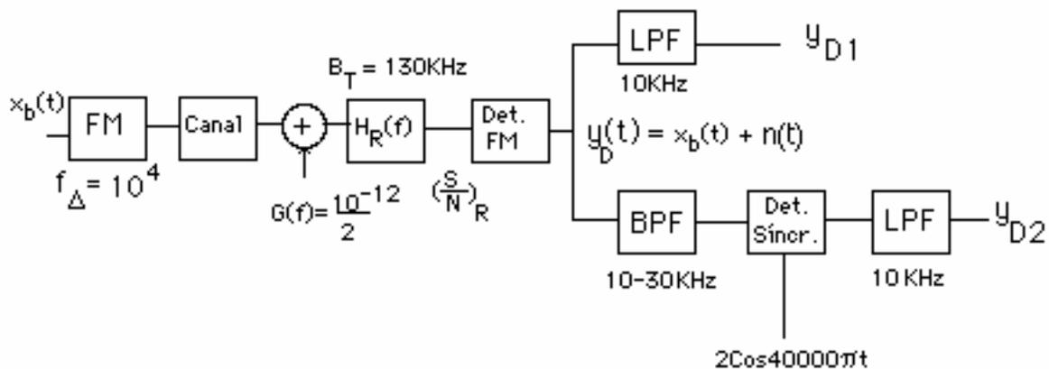
En el sistema mostrado  $x_b(t)$  es el mensaje, el cual viene dado por  $x_b(t) = x_1(t) + x_2(t)\cos 40000\pi t$ , donde tanto  $x_1(t)$  como  $x_2(t)$  tienen potencia promedio unitaria y ancho de banda igual a 10KHz. Si la potencia  $S_R$  que le llega al detector FM es de 1 mw, calcule las relaciones señal a ruido  $(S/N)_{D1}$  y  $(S/N)_{D2}$
