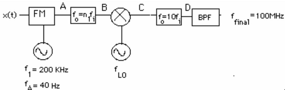
En el modulador mostrado se sabe que el mensaje es un tono de 4KHz y amplitud unitaria. Si  $\beta_C = 3$ , determine los anchos de banda en los puntos A,B,C,D.
