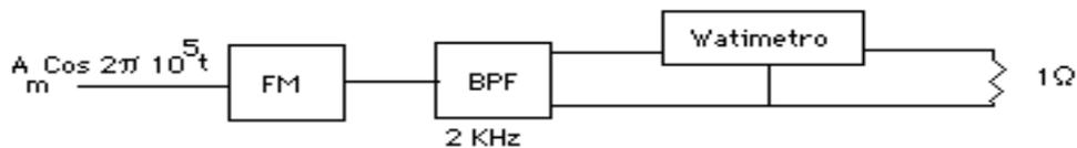
En el esquema mostrado en la figura en el cual el filtro pasabanda está centrado a la frecuencia de portadora, se hacen las siguientes pruebas:
