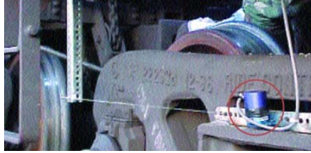
Monitorización de la suspensión de un tren
