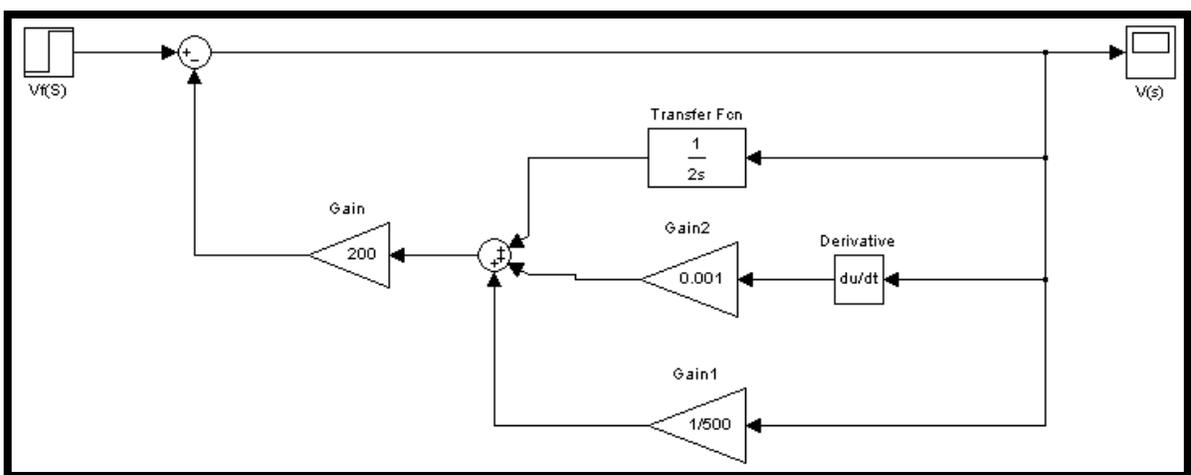
El voltaje Vf va de 0 a10
